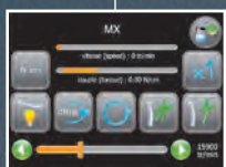
MOTEUR MX À INDUCTION Affichage et présélection de la vitesse des micro-moteurs. Réglage du couple et fonctions auto-reverse et auto-forward.
